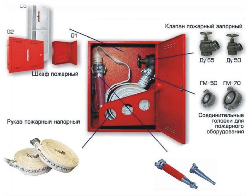
Пожарный рукав следует хранить сухим, сложенным в “гармошку” или двойную скрутку, присоединенным к крану и стволу и не реже одного раза в шесть месяцев перекачивать.
